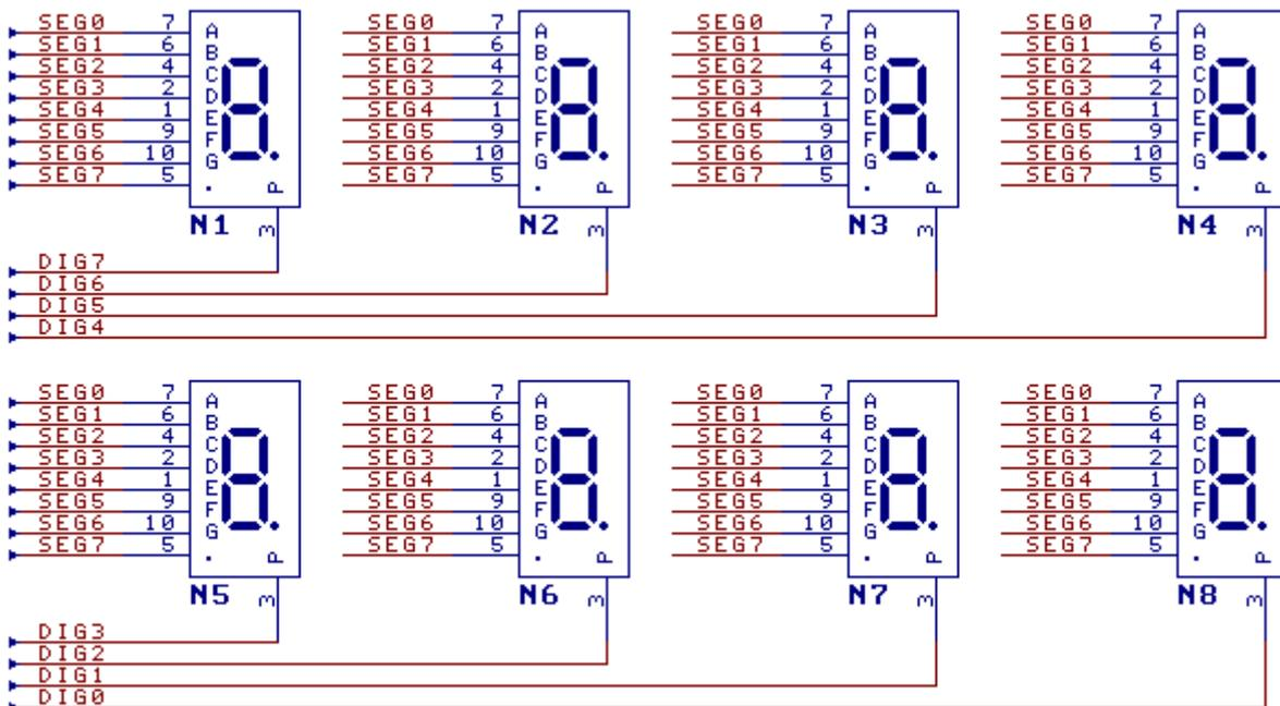
CH452 可以动态驱动 8 个共阴数码管，所有数码管的相同段引脚（段 A~段 G 以及小数点）并联后通过串接的限流电阻 R1（或 R12）连接 CH452 的段驱动引脚 SEG0~SEG7，各数码管的阴极分别由 CH452 的 DIG0~DIG7 引脚进行驱动。
