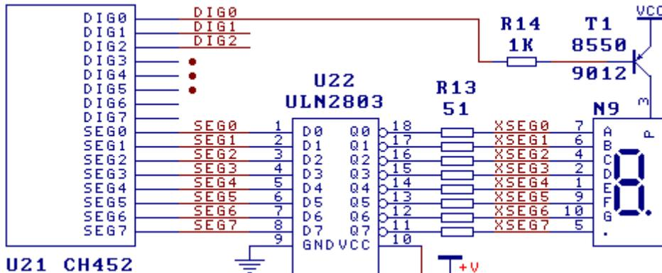
下图是简单的大电流共阳驱动应用电路，设置 CH452 的字驱动 DIG 输出极性为“高电平有效”，用 N-MOSFET 同时实现降压和大电流驱动，通常情况下可以省去段驱动的限流电阻 R13。
