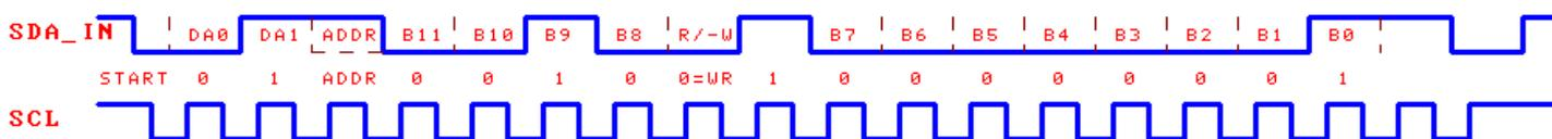
上图是单片机通过 2 线串行接口向 CH452 发送 12 位数据的波形示意图，数据是 00100000001<sub>B</sub>，ADDR 用于选择设备地址，图中以虚线表示。
